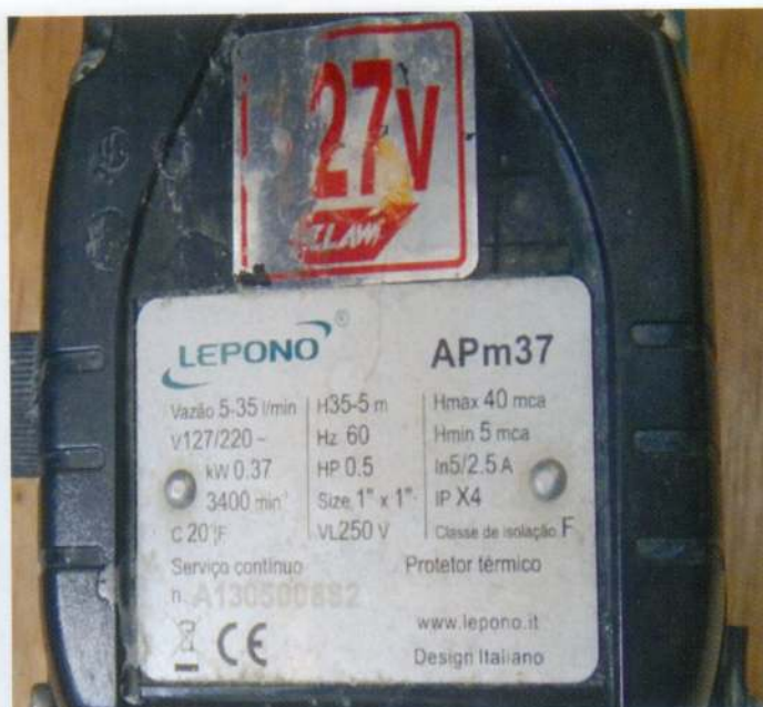
Fig. 15-Detalhe com as especificações da bomba que mistura o adubo em 30 l de água e que fornece pressão para a fertilização foliar.
