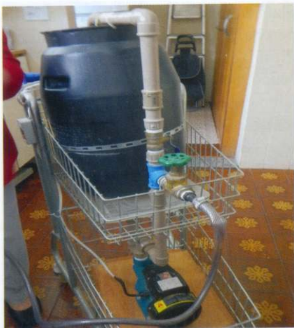
Fig. 14- Um carrinho de supermercado, com instalação elétrica, foi adaptado para misturar os fertilizantes e poder circular por todos os "orquidários" do apartamento.
