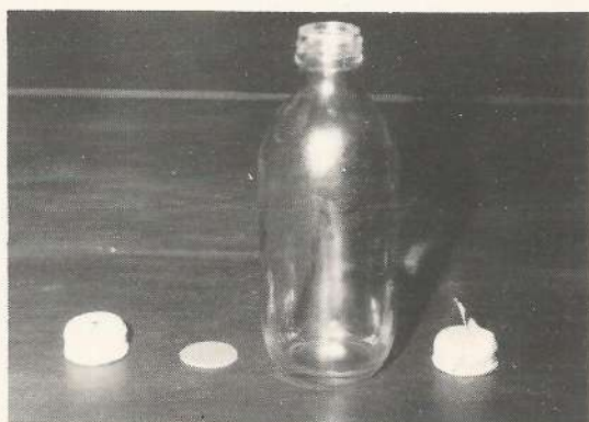
Frasco já preparado, mostrando-se tampa já perfurada, diafragma de borracha e tampa já com esparadrapo.
