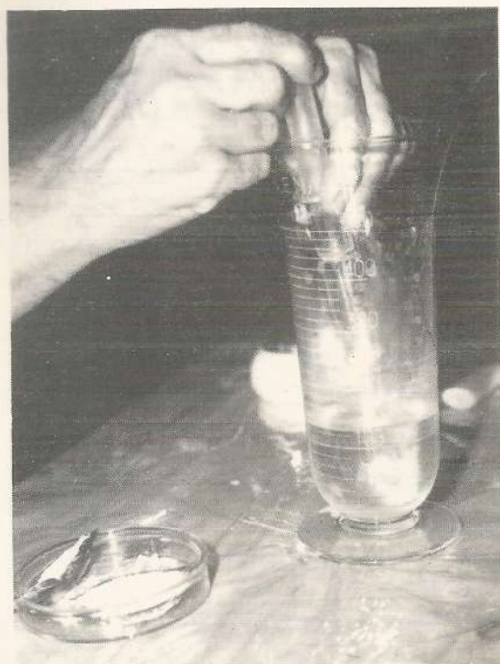
Enchendo a seringa com solução de cloreto de cal.
