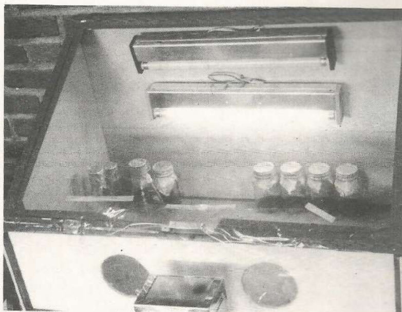
Capela sendo preparada para operação. A luz, inferior, acesa, é germicida — UV. Ao fundo, frascos com meio de cultura, apenas cobertos de papel laminado.
